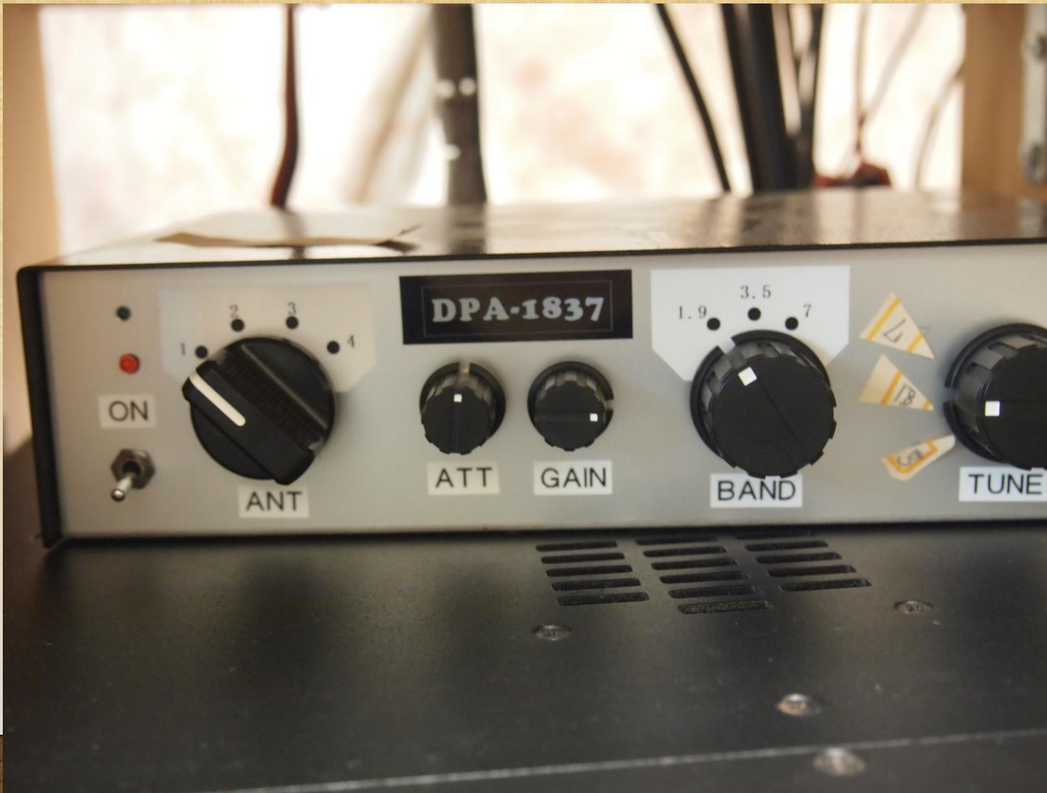
受信アンテナのプリアンプ (160m用)
